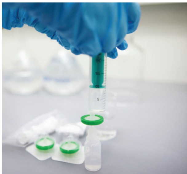
1. ábra Szemcsepp steril szűrése. A szemcseppentő flakon és a fecskendő között helyezkedik el a fecskendőre helyezhető (jelen esetben zöld peremű) membránszűrő feltét (fecskendőszűrő).
