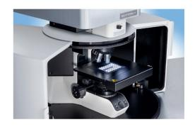
A molekuláris szerkezet vagy morfológia változásainak kimutatása és a tartalom egyenletes eloszlásának, homogenitásának és részecskeméretének kiértékelése mind lehetséges Raman-mikroszkópiával. Ennek a nagy teljesítményű spektroszkópiai módszernek a szabályozott környezetben történő használatához ugyanolyan erős és validált eszközre van szükség és a Bruker SENTERRA II Raman képalkotó mikroszkóp készen áll ezeknek a feladatoknak az elvégzésére.
