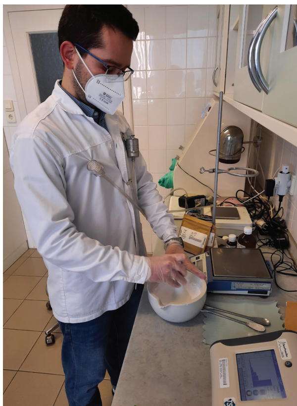
3. ábra Aeroszol-mintavétel gyógyszerkészítés közben ruházaton viselhető személyi mintavevőkkel
