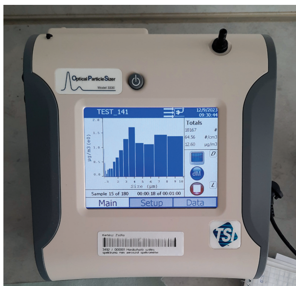
4. ábra A kísérletek során használt optikai részecskeszámláló
